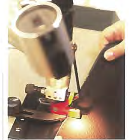
Für die perfekte Naht sorgen spezielle Industrienähmaschinen. Für Zier- oder Montage-naht verwenden die Näherinnen unterschiedliche Material- und Nähgarnstärken.
