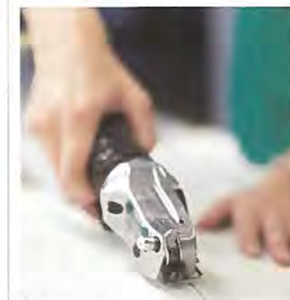
Das Material wird per Hand angezeichnet. Die Schablonen werden zuvor aufgelegt und bestmöglich in der Haut verteilt, wobei vor allem die Naturmerkmale des Leders beachtet werden müssen. Mit einer „pneumatischen Handschere“, so der Fachausdruck, wird das Leder geschnitten.
